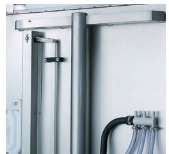
Steigleitungen ausserhalb der Waschkammer in robuster CrNi-Stahl-Aus- führung.
